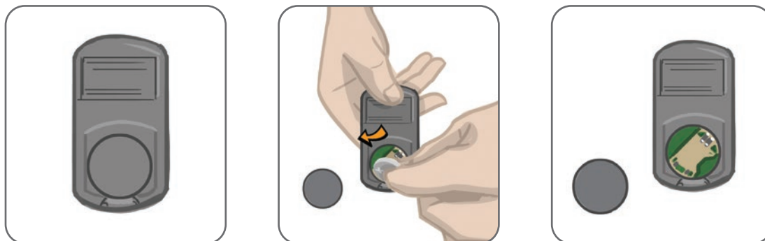
Slika 11-2: Zamjena baterije upravljačke jedinice
