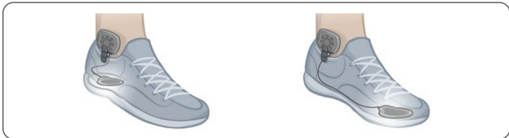
Slika 6-19: Konačni položaj senzora za stopalo pričvršćenog na obuću.
