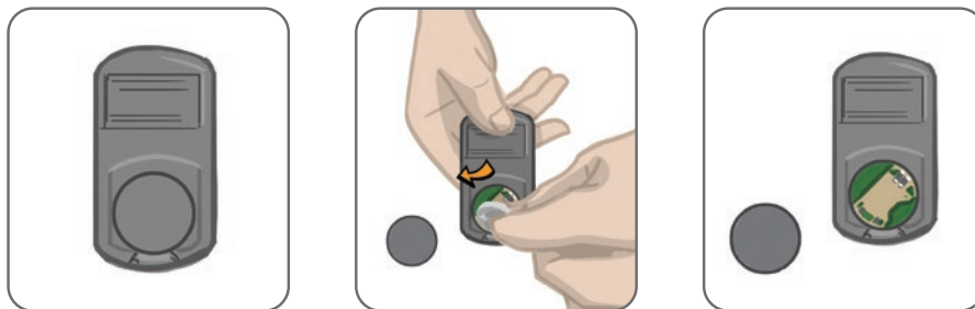
Slika 8-2: Zamjena baterije upravljačke jedinice
