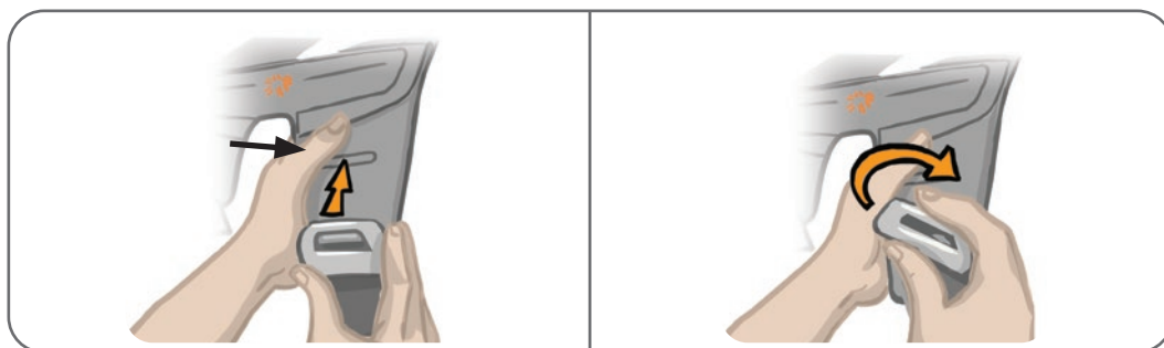
Slika 8-13: Uklanjanje remenja za bedro
