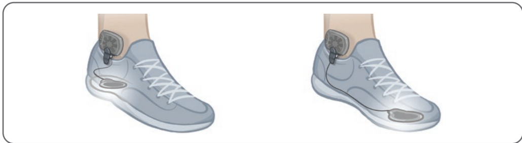
Joonis 6-19. Jalatsisse paigaldatud jalalabaanduri lõplik asend
