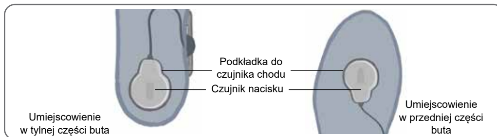
Rysunek 8-13: Dostosowywanie położenia czujnika na stopę w bucie
