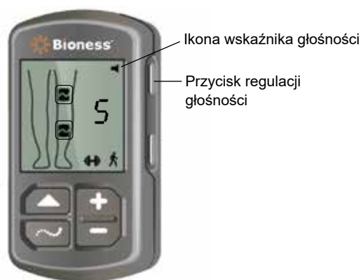
Rysunek 4-10: Przycisk regulacji głośności na module sterowania
