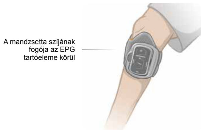
6-1. ábra: A jobb lábra rögzített normál méretű lábszármandzsetta.
