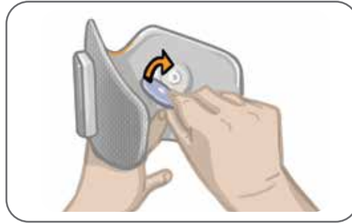
الشكل 8-5: توصيل الأقطاب الكهربائية القماشية المستديرة
