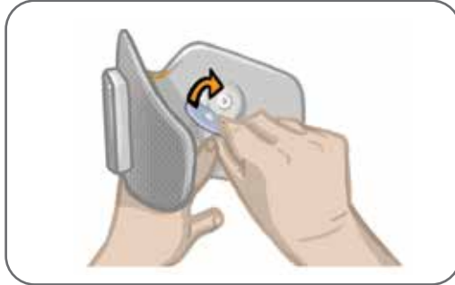
الشكل 6-6: توصيل الأقطاب الكهربائية القماشية المستديرة
