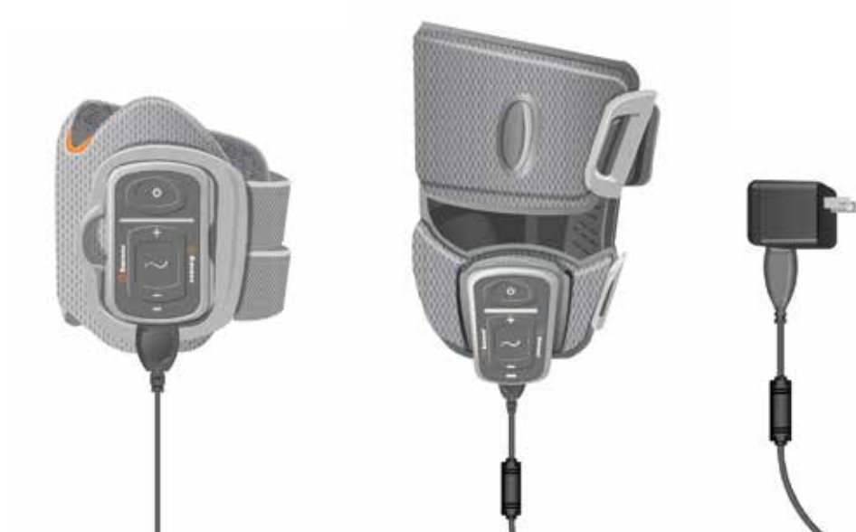
Figur 6-2: Ladeoppsett for L300 Go-systemet (eksempel på en konfigurasjon med leggmansjett og lårmanjsjett)
