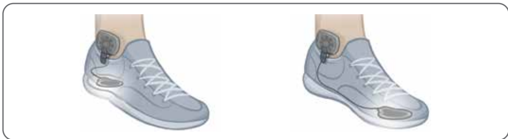
Figur 6-19: Fotsensorens endelige posisjon når den er festet til sko
