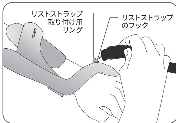
図 8-11: リストストラップのフックの取り付け
