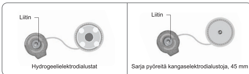
Kuva 6-3: normaalin säärimansetin elektrodialustavaihtoehdot
