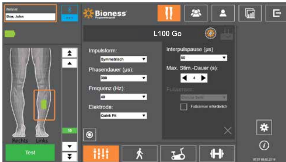
Abbildung 9-4: Stimulationsprogrammierung, Parameter-Bildschirm mit Fenster für erweiterte Einstellungen
