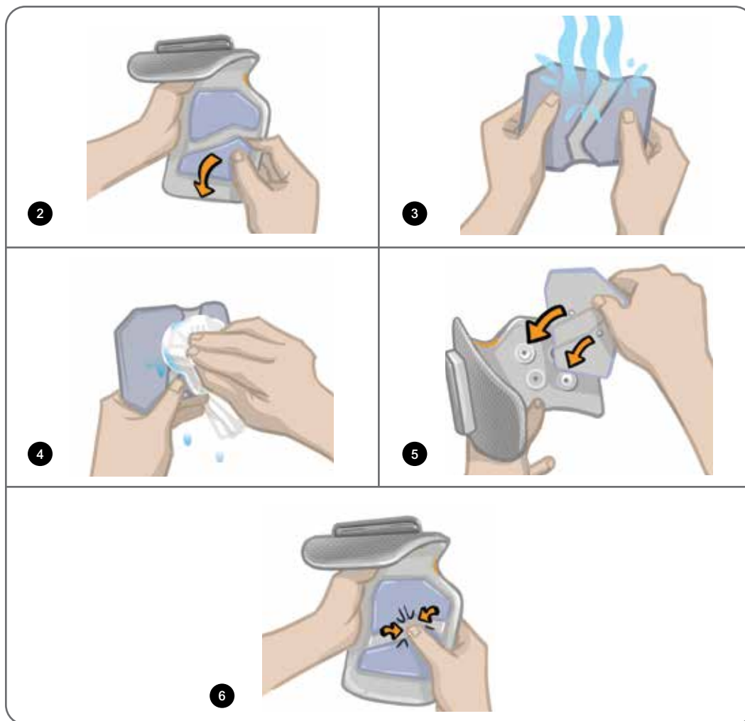
Abbildung 11-1: Austauschen der Quick-Fit-Elektrode
