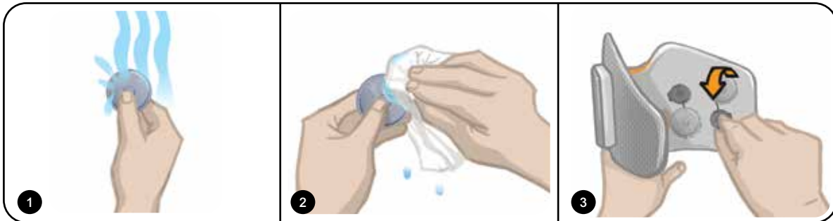
Abbildung 8-10: Anpassen der runden Gewebeelektrode
